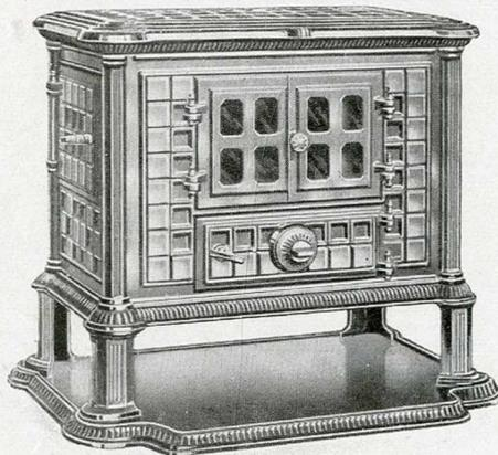
Cet appareil brûle indifféremment le bois, la lignite, le charbon, les boulets ou le coke. Il comporte des portes ouvrantes en façade, un cendrier avec régulateur, une porte de chargement du bois sur le côté et un dessus basculant avec tampon pour chargement des combustibles. Ce tampon mobile permet éventuellement la cuisson.
